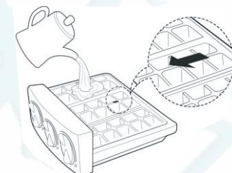
4. Поверните кнопку льдогенератора, и лед автоматически заполнит нижнее отделение после его генерирования. Вытяните отделение для льда.
